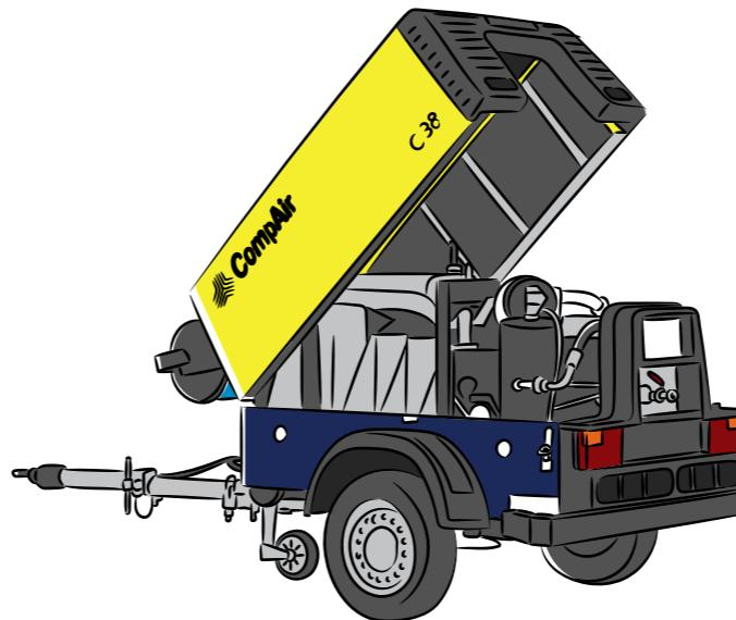
Die Modelle der C- Baureihe sind fahrbare Kompressoren mit 4-Zylinder Dieselmotor, drehzahlgeregelt abhängig vom Druckluftbedarf, mit integriertem Nachkühler und automatischer Kondensatabscheidung.
